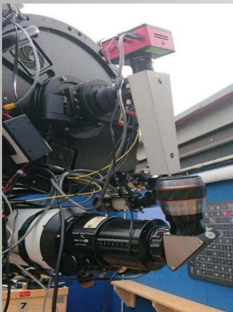
**Abb.6:** BACHES Echelle Spektrograph und CCD-Kamera SBIG STF-8300M am Planewave CDK20 (Fotos: Autoren)
