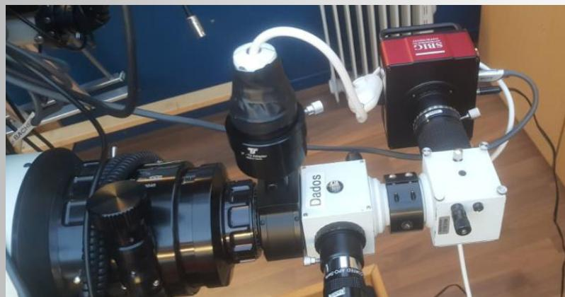
**Abb.5:** DADOS Spektrograph mit angeschlossener CCD-Kamera SBIG STF-8300M
